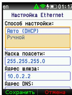
4.2. С помощью клавиши  $\Delta$  перейдите в поле «Способ настройки», выберите режим подключения IP-адреса «Авто (DHCP)» или «Ручной» (в зависимости от настроек вашей сети) и нажмите клавишу любую клавишу.
