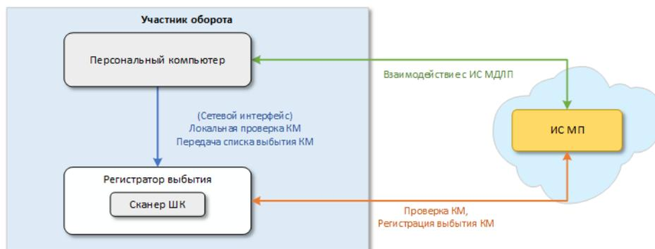
Рисунок 7 – Вариант удалённого подключения РВ КМ
